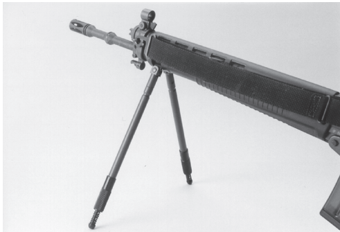
Bild 2: Verstellbare Zweibeinstütze zu Stgw 90, diverse Fabrikate
