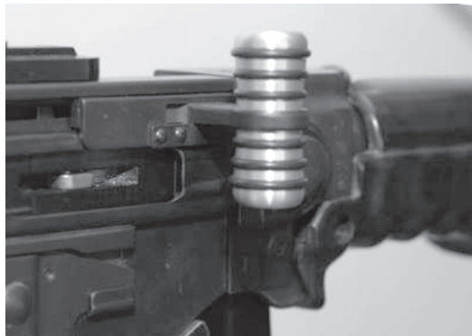
Figura 34: leva d'armamento anatomica per F ass 57
