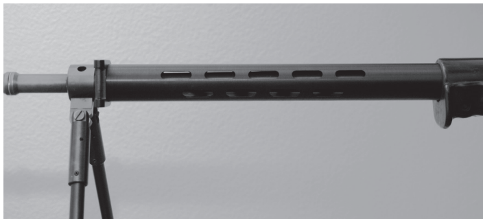
Bild 31: Mantelrohr zu Stgw 57
