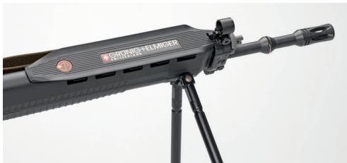
Bild 14: Flimmerband Stgw 90 der Firma Grünig Elmiger
