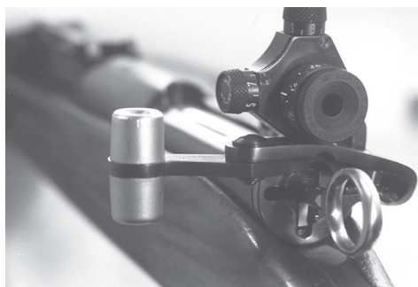
Figure 37: Verrou à gauche pour mousqueton 31
