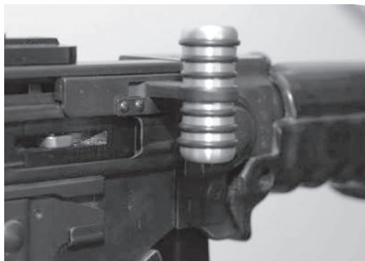
Bild 34: Poignée de charge anatomique pour F ass 57
